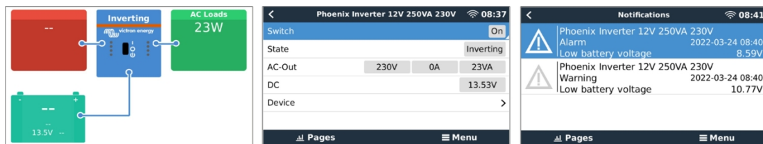
Exemplos de ecrãs GX, da esquerda para a direita: ecrã do sistema, ecrã do dispositivo do inversor e mensagem de alarme.
