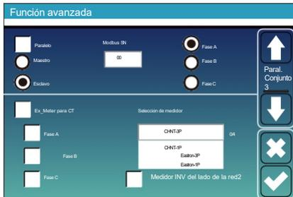
**Ex\_Meter Para CT:** en un sistema trifásico con medidor de energía trifásico CHNT (DTSU666), haga clic en la fase correspondiente a la que está conectado el inversor híbrido. Por ejemplo, si la salida del inversor híbrido está conectada a la fase A, haga clic en «Fase A».
