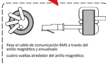
Pase el cable de comunicación BMS a través del anillo magnético y envuélvalo cuatro vueltas alrededor del anillo magnético.
