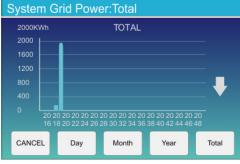
La curva de energía solar diaria, mensual, anual y total se puede comprobar aproximadamente en la pantalla LCD. Para obtener una generación de energía más precisa, consulte el sistema de monitorización. Haga clic en las flechas arriba y abajo para comprobar la curva de energía de diferentes periodos.
