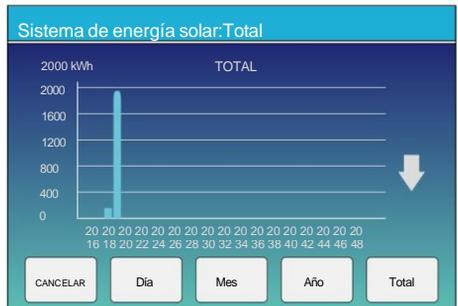
La curva de energía solar diaria, mensual, anual y total se puede verificar de manera aproximada en la pantalla LCD. Para una generación de energía más precisa, verifique en el sistema de monitoreo. Haga clic en las flechas hacia arriba y hacia abajo para verificar la curva de energía de diferentes períodos.
