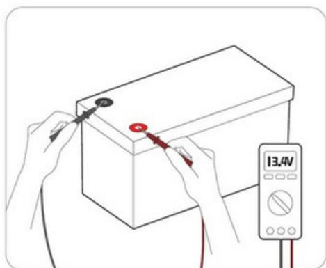
**Paso 3: Haga las conexiones como indica la gráfica y **ATORNILLE FIRMEAMENTE (Torsión máxima 11 N.m)****
