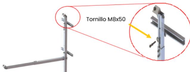
**Q** Nota: Al realizar la instalación, asegúrese de que la combinación del mini raíl y el soporte de varilla telescópica se encuentra en un estado mutuamente vertical, lo que resulta conveniente para la posterior fijación a la pequeña barandilla con la combinación de placas de aluminio y pernos.
