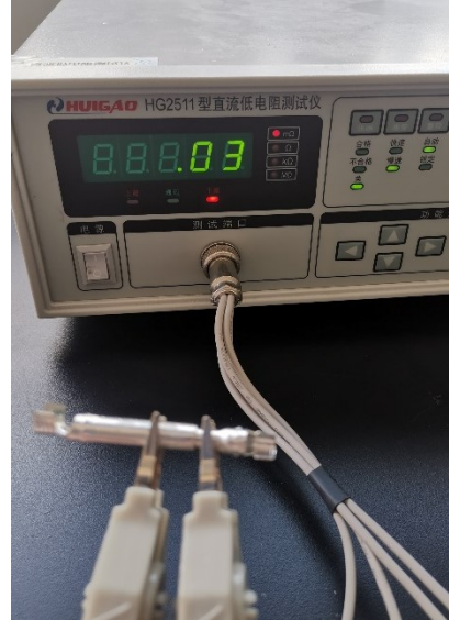
图片 6 插针 & MC4 插套 pin & MC4 socket
