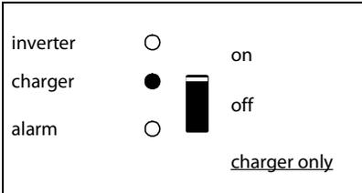
De netspanning is doorgeschakeld en de lader staat in bulk of absorption mode.
