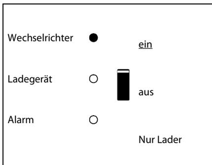
Der Wechselrichter ist eingeschaltet und liefert Leistung an die Verbraucher Batteriebetrieb.
