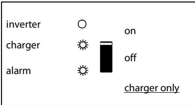
De netspanning is doorgeschakeld en er is een vooralarm: overbelast of de lader is warm.
