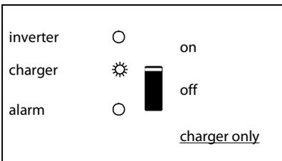
La tension d'entrée CA est commutée et le chargeur fonctionne en mode float.
