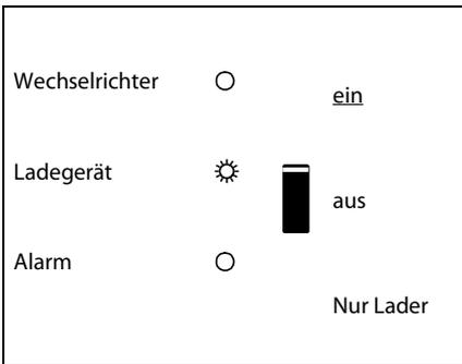
Die Wechselfspannung ist durchgeschaltet und das Ladegerät arbeitet im Spannungs-Erhaltungsmodus
