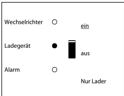
Die Wechselspannung ist durchgeschaltet und das Ladegerät arbeitet im Konstantstrom- oder Konstantspannungs-Modus.
