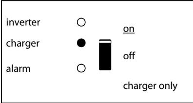
De netspanning is doorgeschakeld en de lader laadt in de bulk mode en of absorption mode.
