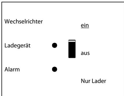
Die Wechselspannung ist durchgeschaltet und das Ladegerät ist abgeschaltet. Das Ladegerät erreicht nicht die Sollspannung (bulk protection Modus).
