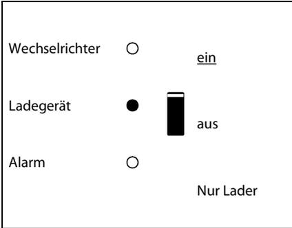
Die Wechselfspannung ist durchgeschaltet und das Ladegerät arbeitet im Konstantstrom- oder Konstantspannungs-Modus.
