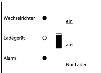
Der Wechselrichter ist ausgeschaltet.
