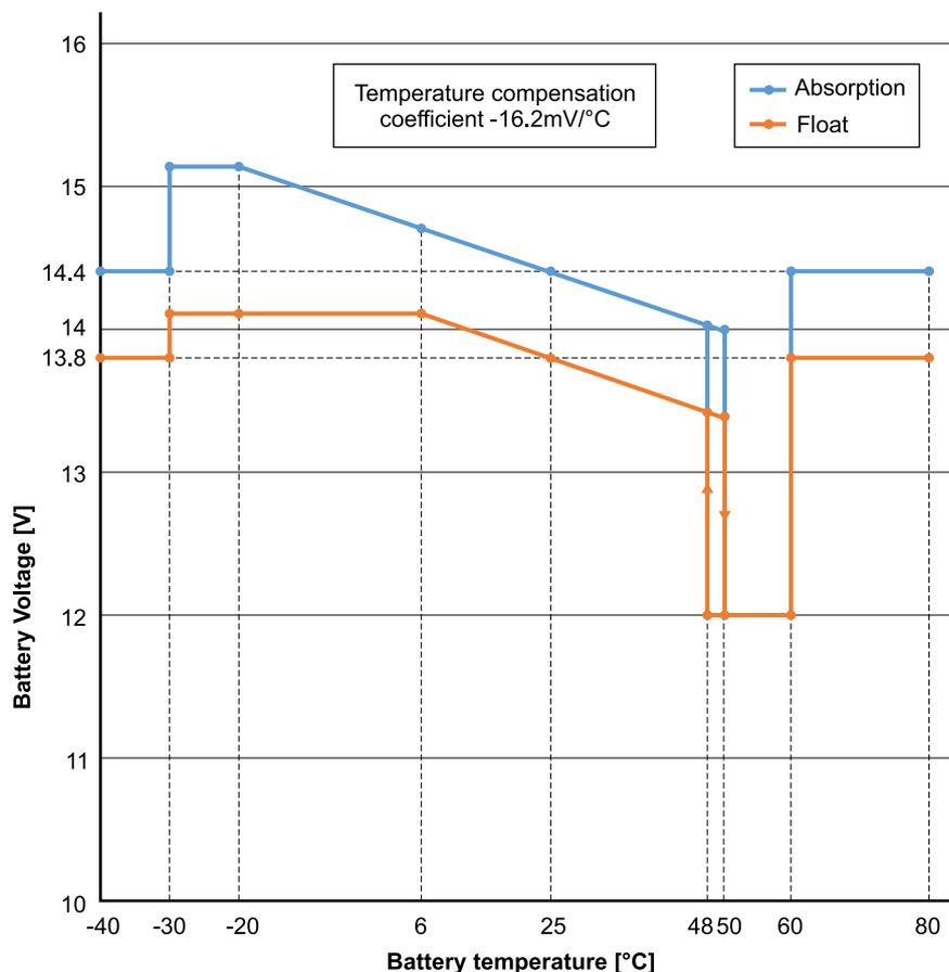
Con un sensor de temperatura instalado en el bloque de conexión I/O del usuario, se usará la temperatura real de la batería para la compensación, a lo largo del día.
