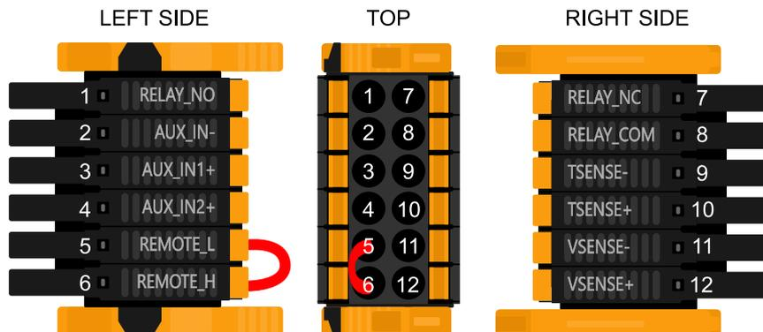
El conector I/O del usuario se sitúa en la parte inferior izquierda de la zona de conexión. El diagrama muestra tres perspectivas. Parte izquierda - Parte superior - Parte derecha
