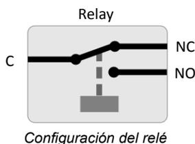
Revise el ajuste de la función del relé con VictronConnect. Al examinar el relé, observe si sus contactos se abren y se cierran cuando el relé tiene corriente y cuando el relé no tiene corriente.
