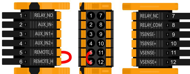
El conector I/O del usuario se sitúa en la parte inferior izquierda de la zona de conexión, el diagrama muestra tres perspectivas. Parte izquierda - Parte superior - Parte derecha
