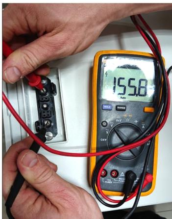
Si el voltaje medido se desvía significativamente del valor nominal, verifique el voltaje eléctrico en los módulos individuales, como se muestra a continuación.
