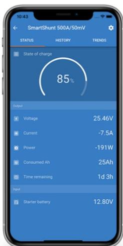
El SmartShunt IP65 es un monitor de batería todo en uno, pero sin pantalla. Utiliza la pantalla de su teléfono.
