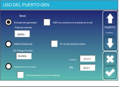
Potencia nominal de entrada del generador: Potencia máxima permitida del generador diésel.
