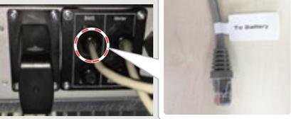
**E** El otro extremo del cable "A la batería" debe conectarse al puerto CAN de la batería de Alpha.
