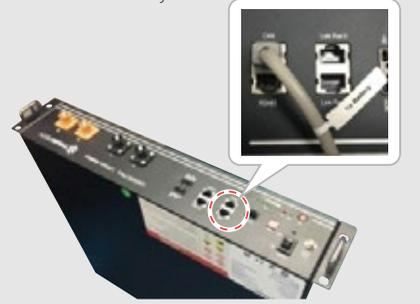
**G** Una vez finalizadas todas las conexiones y ajustes, compruebe si la comunicación con la batería es correcta en PV Master ("Parámetro" → "Estado BMS"), donde debería indicar "Comunicación normal".
